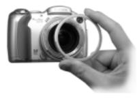
Zuerst nehmen Sie den Abdeckring durch drehen in Pfeilrichtung, bei gleichzeitigem Drücken auf den Knopf A, ab. Setzten Sie den Adapter so an, dass sich die Punktmarken \* gegenüber stehen.
